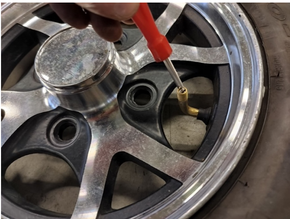
Laita venttiilin sielu paikoilleen. (venttiilityökalu).
