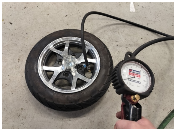
Täytä rengas oikeaan käyttö paineeseen. (1.8–2.2 bar) (renkaan ilman täyttölaite).
